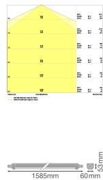
Technische Daten Ledvance LED Feuchtraumleuchte 62W 7500lm - 840 Kaltweiß | 150cm
