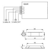
Technische Daten Philips HID-PV m 20 / I CDM HPF 220-240V 50/60Hz für 20W
