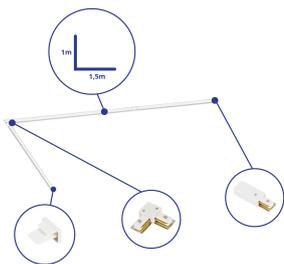
Technische Daten Rail Set 1-Phasen L 1x 1,5 Meter Weiß | incl. Abschlusskappe, Stromanschluss und L - Verbinder
