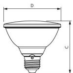
Technische Daten Philips Master Value LED Glühbirne Reflektor E27 PAR30S 9.5W 760lm 25D - 930 Warmweiß | Höchste Farbwiedergabe - Dimmbar - Ersatz Für 75W
